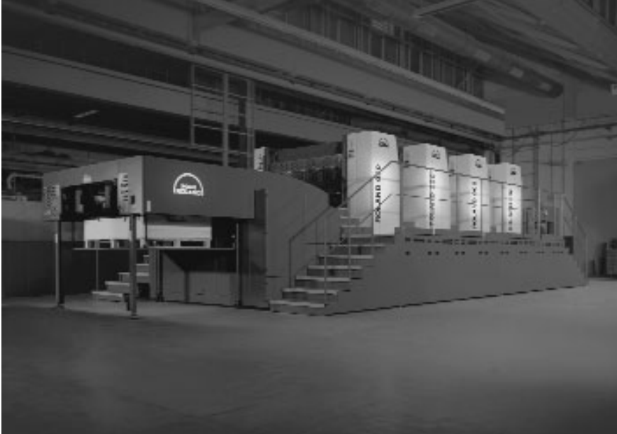
Trend zu immer schnelleren und größeren Druckmaschinen, z. B. die MAN Roland 900 XXL mit einer maximalen Druckbreite von 1,85 Metern (Abbildung: © MAN Roland Druckmaschinen AG)
